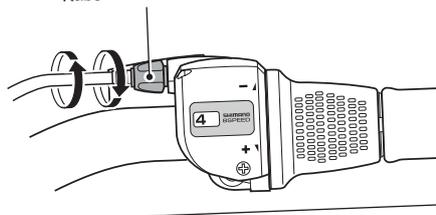
2. Schneiden Sie nach dem Einstellen der Schalteinheit das vorstehende Kabel ab und bringen Sie eine Kabelkappe an.
