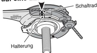
Drehen Sie die Kabeleinstellschraube des Schalthebels, um die gelben Markierungslinien aufeinander auszurichten. Stellen Sie danach den Schalthebel von **4** auf **1** und wieder zurück auf **4** und kontrollieren Sie, ob die gelben Markierungslinien immer noch aufeinander ausgerichtet sind.
