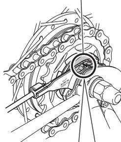
Auf der Schalteinheit sind gelbe Markierungslinien an zwei Stellen vorhanden. Verwenden Sie die Linie, die am einfachsten zu sehen ist.
