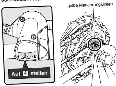
Auf der Schalteinheit sind gelbe Markierungslinien an zwei Stellen vorhanden. Verwenden Sie die Linie, die am einfachsten zu sehen ist.
