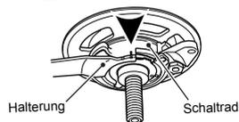
Falls die gelben Markierungslinien nicht gleichgerichtet sind, drehen Sie die Kabeleinstellschraube des Schalthebels, um die gelben Markierungslinien aufeinander auszurichten.
