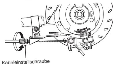
3. Ziehen Sie den Bremshebel an, um die Bremswirkung zu überprüfen und sichern Sie die Kabeleinstellschraube mit der Kabeleinstellmutter.
