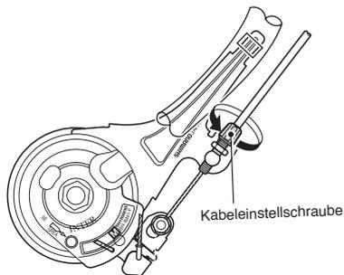
3. Ziehen Sie den Bremshebel an, um die Bremswirkung zu überprüfen und sichern Sie die Kabeleinstellschraube mit der Kabeleinstellmutter.
